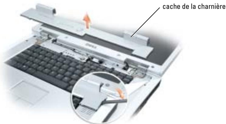
Pour remettre en place le cache de la charnière, insérez tout d'abord son côté gauche, puis appuyez de gauche à droite jusqu'à ce que le cache s'enclenche.
